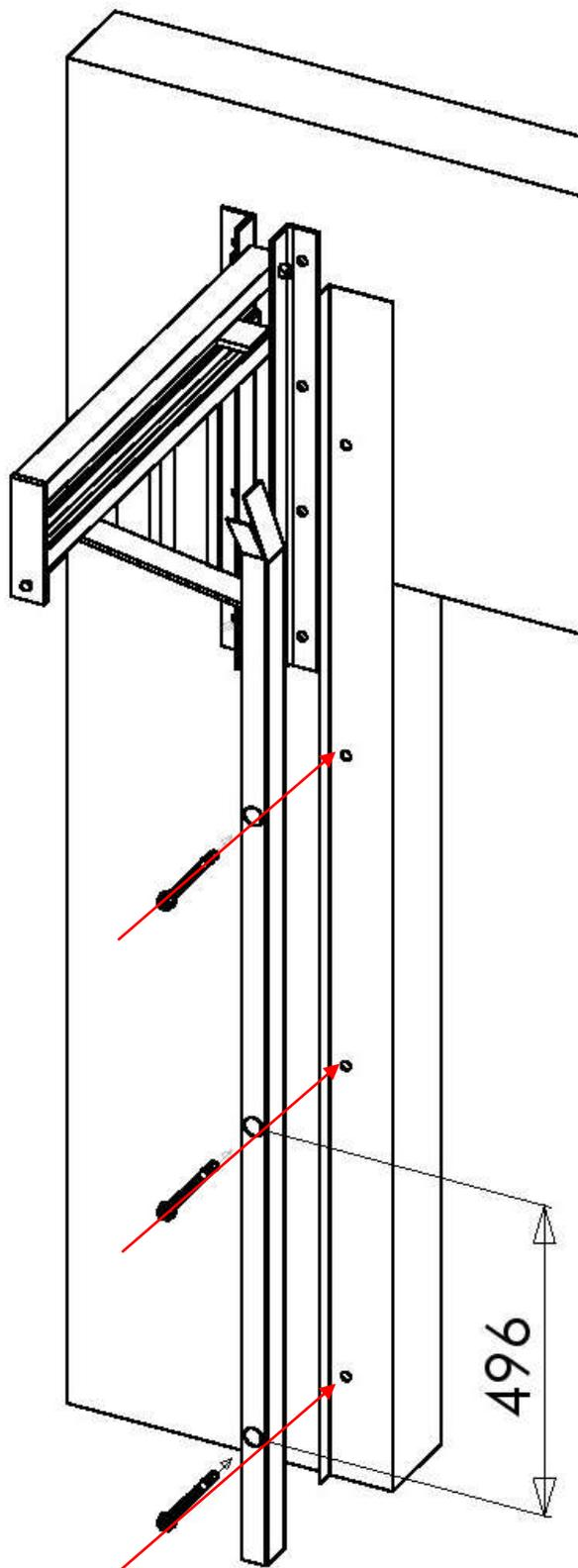
В бетон (кирпич) крепление производится анкерными болтами 8 х 50 мм. К металлоконструкции возможно крепление либо при помощи сварки, либо саморезами с шестигранной головкой D10.
